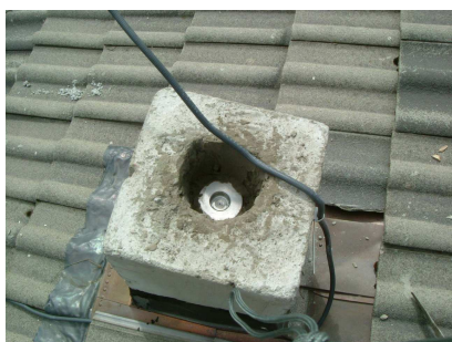
foto 22 – Il vertice cementato in profondità
